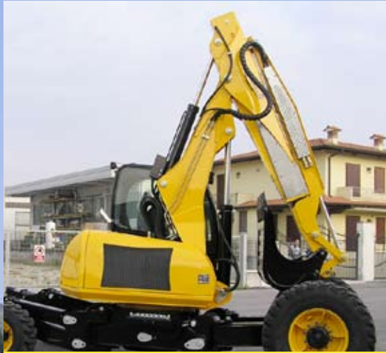
NUOVO DESIGN DEL BRACCIO MINIMO INGOMBRO DI ROTAZIONE.
