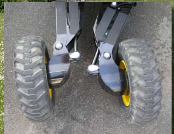
SISTEMA STERZANTE SU RUOTE MOTRICI (optional)
