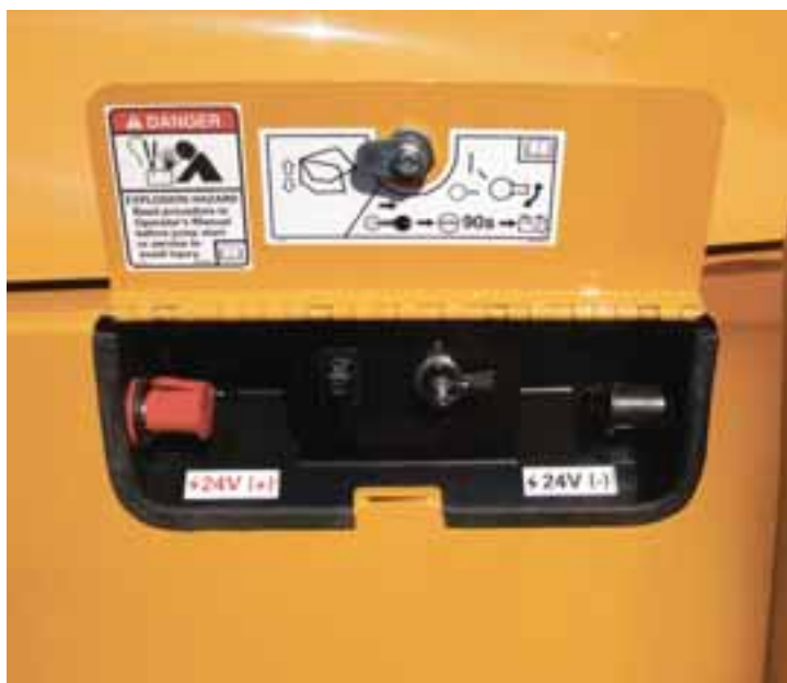
Il cofano si apre anche se la batteria è scarica grazie alla predisposizione esterna per attaccare uno starter
