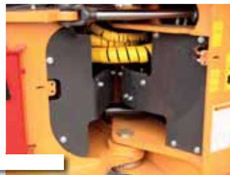
Protezioni sull'articolazione e sulle parti anteriori della pala WH
