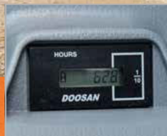
Contatore (di facile lettura dal suolo)
