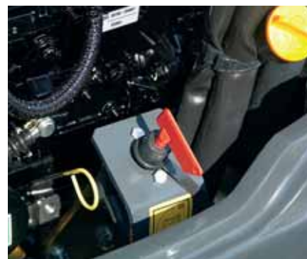
Interruttore di sicurezza dell'impianto elettrico di serie
