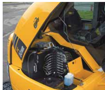
Il cofano destro permette l'accesso al distributore idraulico, al serbatoio del carburante, al serbatoio dell'olio idraulico e alla cassetta porta attrezzi
