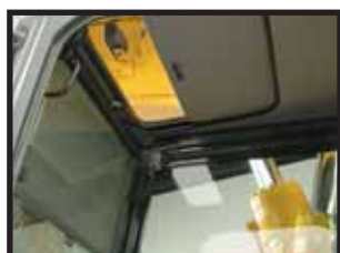
Ampio tettuccio trasparente con parasole integrato
