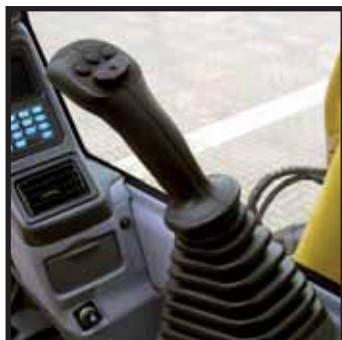
Manipolatori con comando proporzionale per gli accessori
