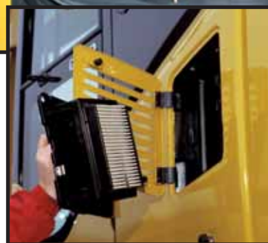
Filtro aria interno cabina
