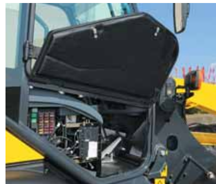
Cofano laterale per rapide operazioni di manutenzione
