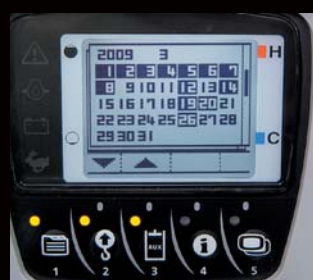
Sistema di registrazione delle operazioni
