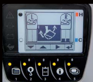
Regolazione del flusso dell'olio (SP1 e SP2)
