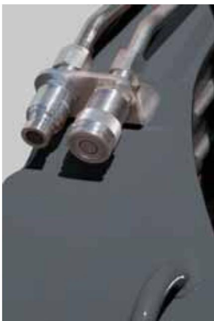
La seconda funzione idraulica ausiliaria può essere ordinata come ricambio DIA kit a partire dal modello L218 in su
