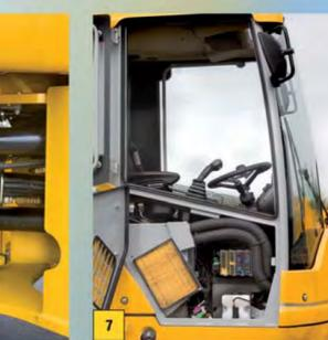
1 Cabina SKY LINE - ampie superfici vetrate - Finestratura tetto con vetro - Comandi ergonomici - Sedile e Joystick multifunzione con regolazioni indipendenti - Vetri con apertura in sagoma della macchina e sbloccaggio all'interno cabina. Pedale freno con funzione INCHING.
