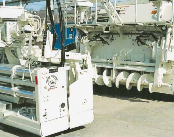
HIGH-PRODUCTION MAINLINE PAVING IS AVAILABLE WHEN FITTED WITH HIGH-PERFORMANCE TEREX® SCREEDS.
