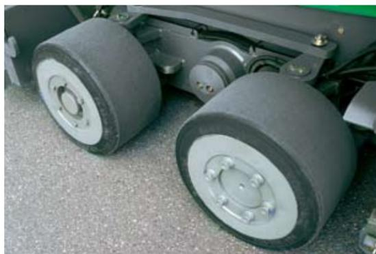
Il piccolo raggio di sterzata e la contenuta lunghezza totale della SUPER 1603-2 permettono di evitare manovre inutili quando gli spazi sono ristretti. Grazie alla grande motricità del sistema di trazione la finitrice avanza rapidamente sia durante la stesa che durante i trasferimenti, a tutto vantaggio della produttività e dell'efficienza.
