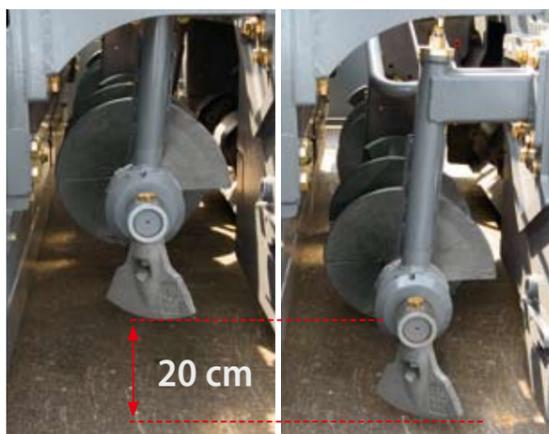
L'ingegnoso sistema di convogliamento del materiale a bordo della SUPER 1603-2 consente di risparmiare tempo e denaro. Grazie alla regolabilità in altezza, ad esempio, non occorre modificare o smontare la coclea distributrice dopo la stesura di uno strato di conglomerato o per spostare la finitrice in un'altra parte del cantiere.
