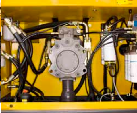
•Facile accesso alle pompe e ai filtri idraulici.
