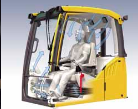
• Il più potente sistema di riscaldamento/raffreddamento del settore con 14 ventole.
