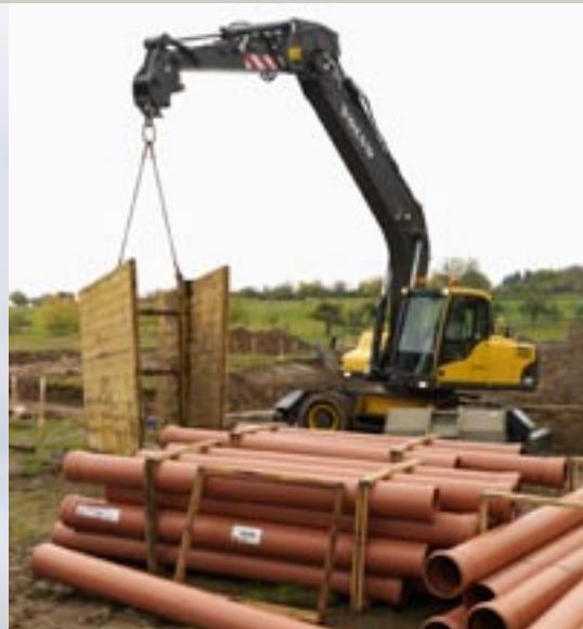
• Capacità di sollevamento e trasporto che compete con quella di un cingolato da 24 tonnellate.
