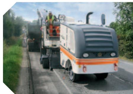
La W 100/W 100i scarifica in modo efficiente strati di pavimentazione spessi fino a 300 mm ▲
