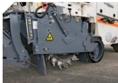
➤ A richiesta le paratie laterali possono essere sollevate e abbassate idraulicamente. In tal modo il cassone del rullo è perfettamente racchiuso e si può lavorare in modo pulito.
