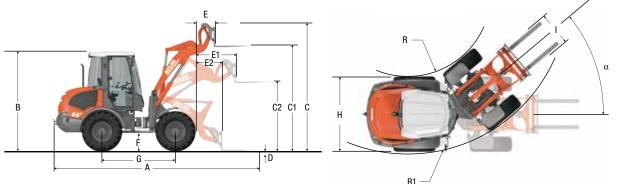
5550 mm Δ 2689 mm В 3420 mm С C1 2975 mm C2 1365 mm 60 mm D Е 460 mm F1 1195 mm E2 725 mm 450 mm F G 2000 mm н 1870 mm 1030 mm Т R 1817 mm 3715 mm **R1** 40° α
