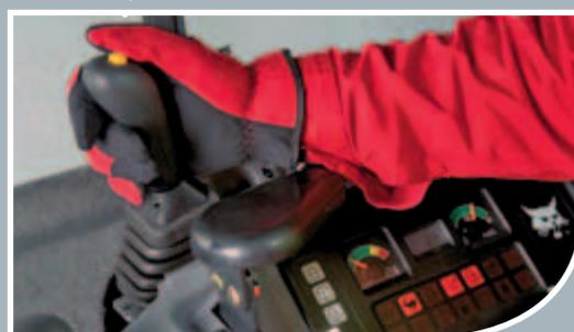
Il terzo joystick controlla la flottazione della lama e l'attivazione dei motori di traslazione con cambio automatico, per un ambiente di lavoro più confortevole.
