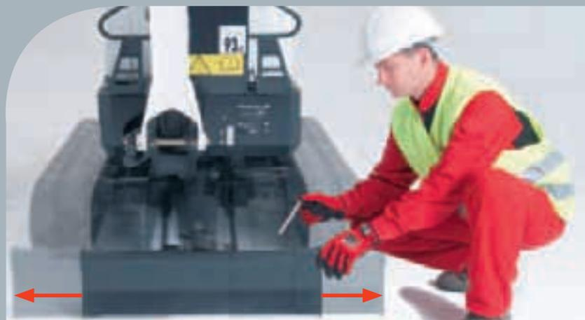
I modelli E08 e E10 sono equipaggiati con sottocarro e lama estensibile di serie. Non c'è alcun bisogno di smontare e rimontare le prolunghesse della lama.
