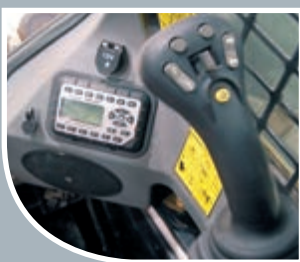
MP3 compatibile predisposizione autoradio stereo (opzionale), presa da 12 V, SJC (opzionale)
