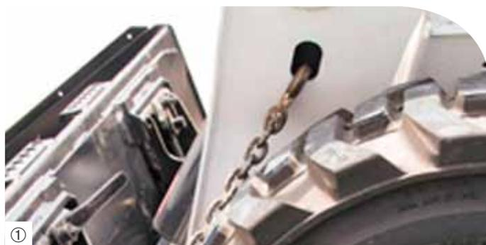
**Semplici ancoraggi della macchina:** di facile accesso, consentono di fissare saldamente e rapidamente la macchina. I nuovi ancoraggi ① sono facilmente individuabili e accessibili.
