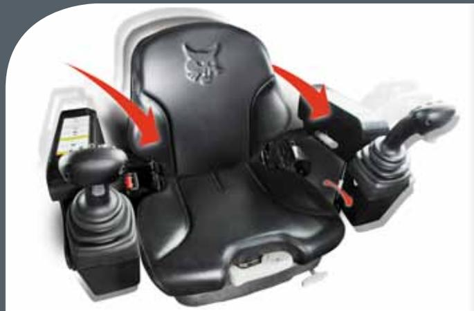
**Posizionamento flessibile del joystick:** i supporti dei joystick sulle macchine dotate di comandi SJC possono scorrere in avanti e indietro, indipendentemente dal sedile, adattandosi alle preferenze personali dell'operatore.
