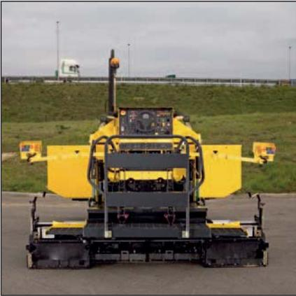
Già con il banco base è possibile ottenere una larghezza di stesa di 2,6 m, procedendo con allargamenti gradualmente, fino a un massimo di 4 m.
