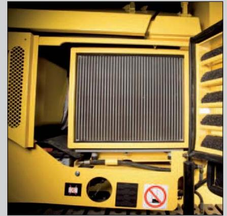
Il vano motore è accessibile da tre lati. Particolare del radiatore di grandi dimensioni.
