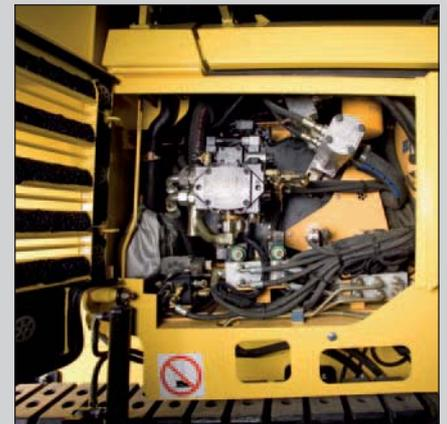
Impianto idraulico centrale facilmente accessibile – pompe, valvole, raccordi, ecc. a portata di mano.
