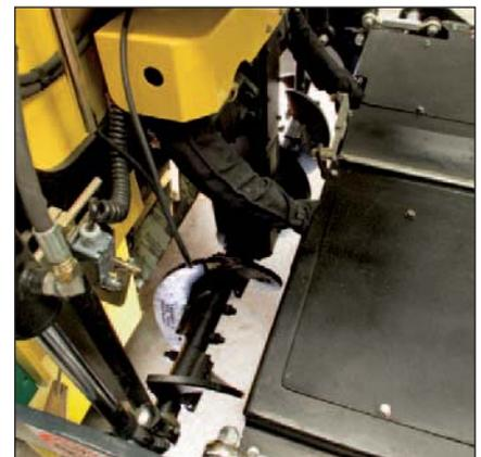
L'altezza delle coclee si regola meccanicamente; a richiesta è disponibile anche la regolazione idraulica.
