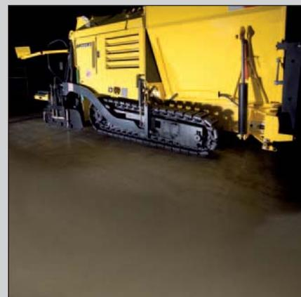
I pattini in gomma avvitati, larghi 200 mm, trasmettono un'elevata forza di trazione anche su un sottofondo disomogeneo.
