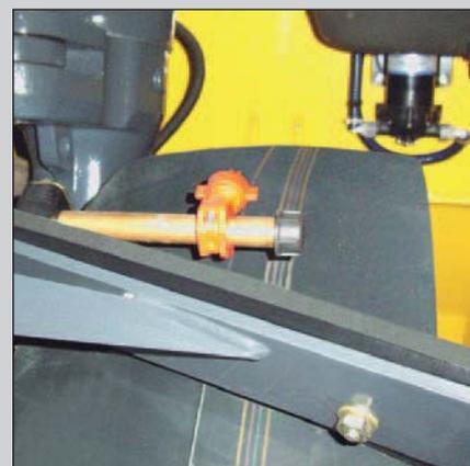
Il sistema di spruzzatura acqua a pressione di serie garantisce una spruzzatura di acqua omogenea, indipendentemente da pendenze o dal livello del serbatoio.
