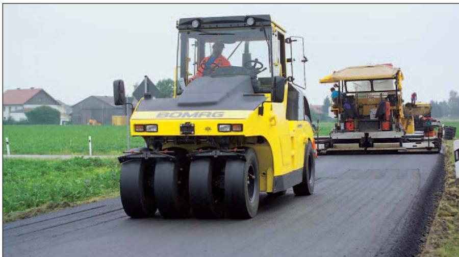
I BW 24 RH e BW 27 RH sono rulli gommati flessibili adattabili a tutte le operazioni di compattazione tipiche nelle opere in asfalto e in terra.
