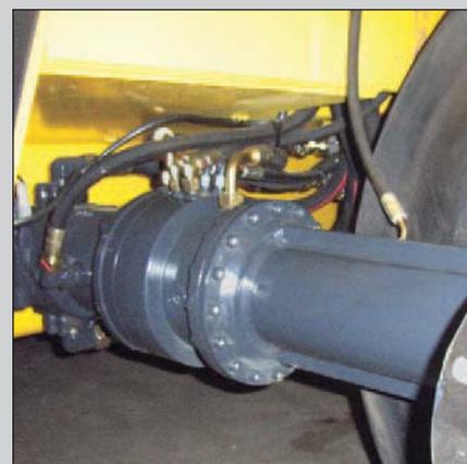
Controllo sensibile della velocità grazie alla trasmissione idrostatica.
