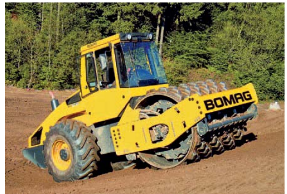
Potente e flessibile nei lavori in discarica: BW 213 DH con mantello vibrocstipatore e ruote da trattore.
