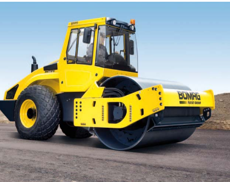
Tamburo liscio BOMAG per impieghi universali.
