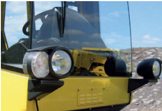
Illuminazione secondo il codice della strada per un funzionamento in sicurezza.
