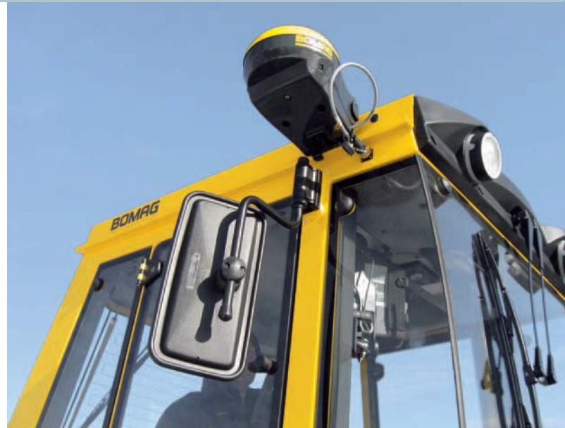
Immediatamente applicabile dappertutto: il ricevitore GPS BOMAG StarFire.
