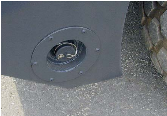
Impianto di rifornimento del carburante sotto pressione per interventi rapidi.
