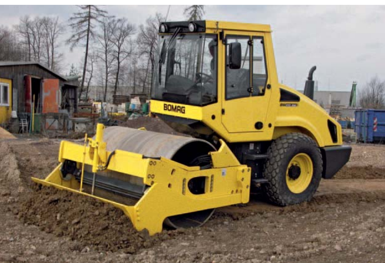
Distribuire e compattare nello stesso tempo: il rullo compattatore con lama di spinta, qui il BW 177 DH-4.
