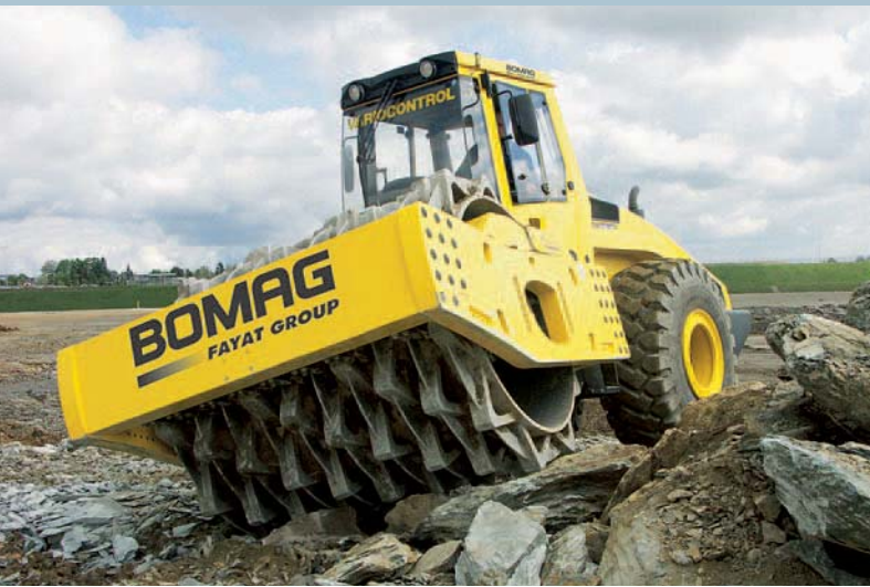
Da rocce morbide a rocce di media durezza – nessun problema per il tamburo frantumatore.
