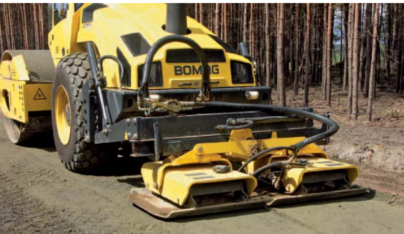
Per una superficie perfetta: BW 213 DH-4 con piastre.
