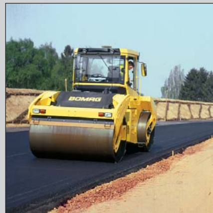
I lavori di asfalto su grandi superfici richiedono rulli particolarmente efficienti: BW 203 AD con ASPHALT MANAGER.
