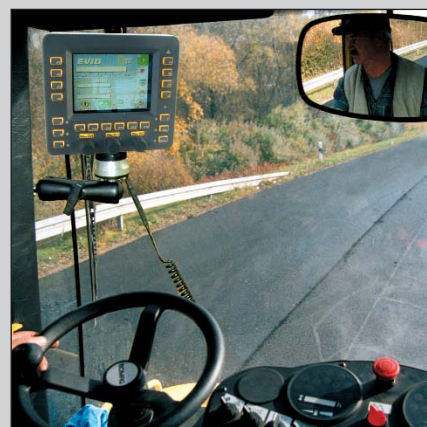
Basta un'occhiata: il display dell'ASPHALT MANAGER mostra tutte le informazioni importanti per la compattazione.
