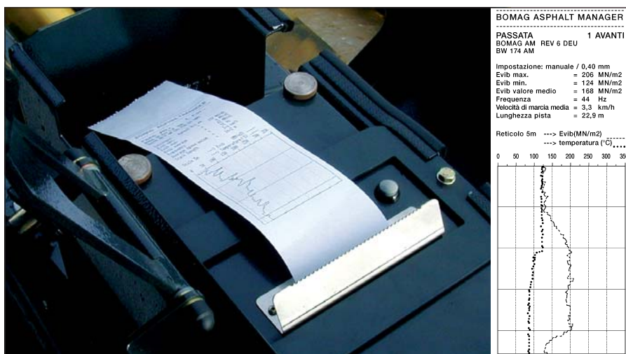
Il protocollo di misura, disponibile direttamente in cantiere.
