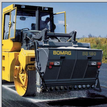
Spandigraniglia di precisione: il BS 180 distribuisce il materiale da spargere in modo omogeneo e preciso.
