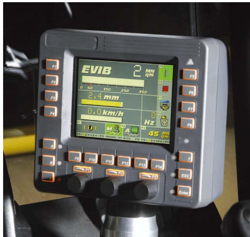
All'operatore viene chiaramente indicato sul display il raggiungimento della compattazione ottimale.
