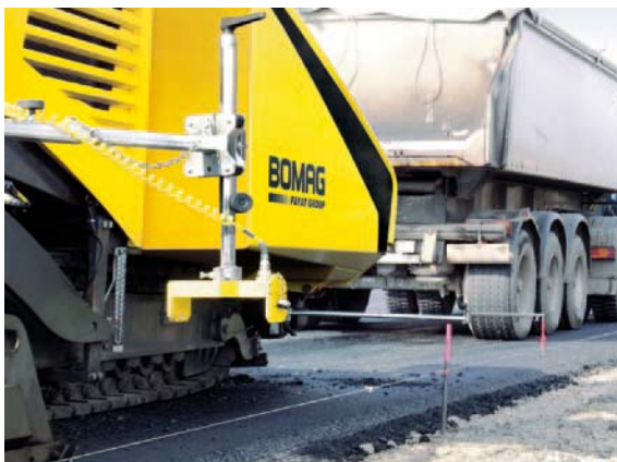
Versatilità: l'interfaccia per la livellazione consente l'impiego di tutti i sistemi e i sensori comunemente in uso.
