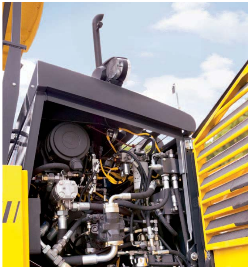
... l'accesso privo di barriere a tutti i componenti dell'impianto idraulico e del motore.
