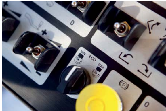
Soluzione tecnica efficiente: BOMAG ECOMODE per un ridotto consumo di carburante, oltre a basse emissioni di sostanze nocive ed emissioni acustiche.
