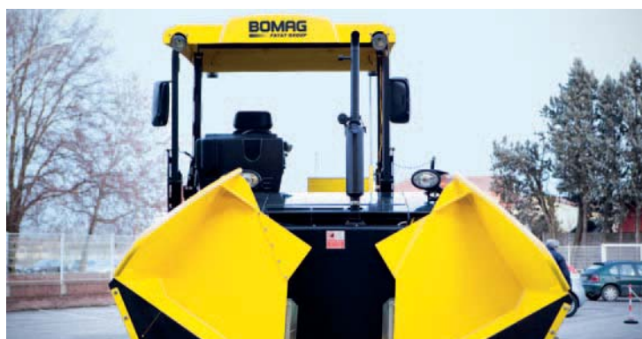
Cambio di prospettiva: il sistema BOMAG SIDEVIEW per una sporgenza laterale fino a 40 cm.
