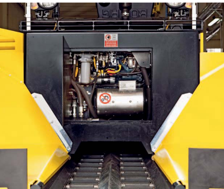
Con una potenza di 13 kW il generatore trifase garantisce tempi di riscaldamento brevissimi.
