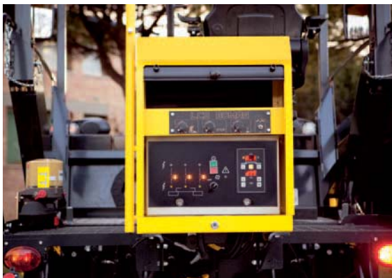
Sempre sotto controllo: pressione del banco e regolazione della temperatura.
