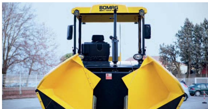
Grazie al sistema BOMAG SIDEVIEW la vibrofinitrice necessita di un unico sedile e un unico quadro di comando.
