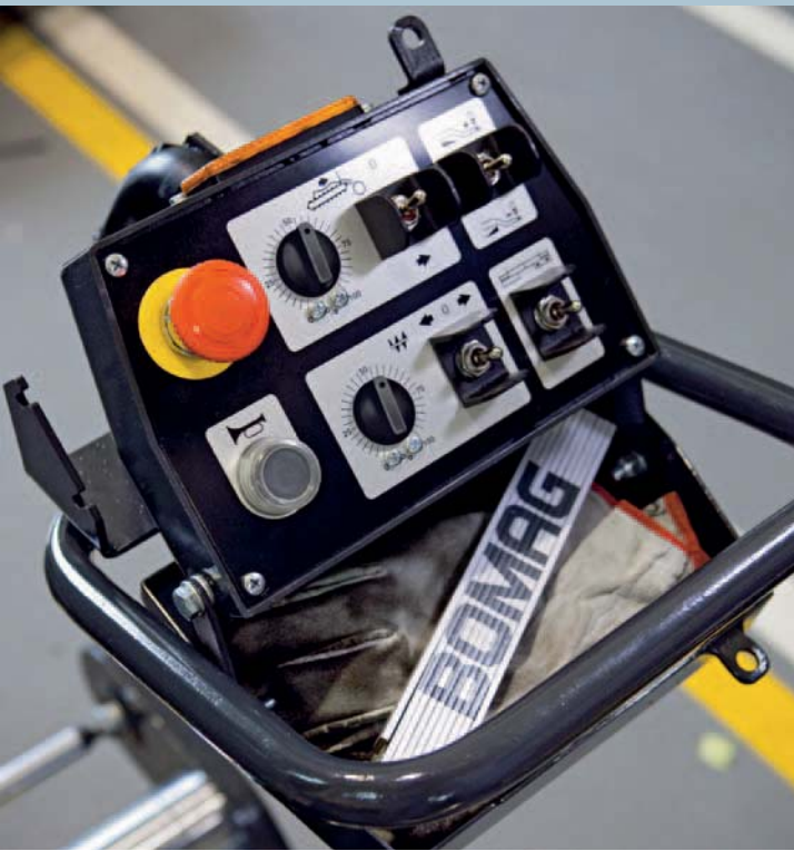
Ottima ergonomia: postazione di comando laterale girevole con ampia possibilità di spostamento e regolazione.
