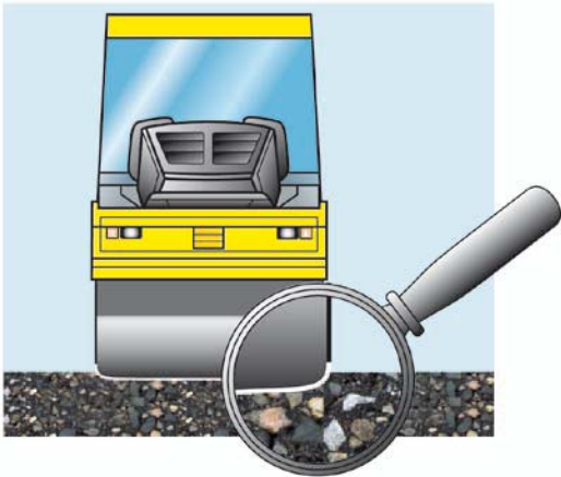
La particolare geometria del tamburo consente passaggi senza stacchi
