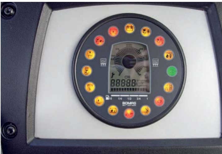
Design moderno del cruscotto con visualizzazione digitale di tutte le funzioni più importanti. Come strumento circolare per rulli della versione AP...
