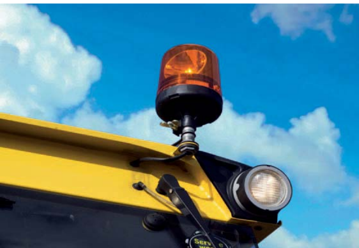
Avvisatore ottico rotante visibile da lontano.
