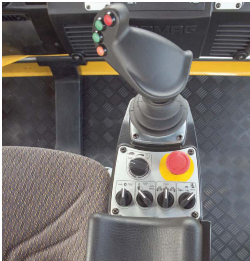
Generatore a impulsi: regolazioni delle vibrazioni, modalità operative o anche velocità di marcia sono sempre a portata di mano per l'operatore.
