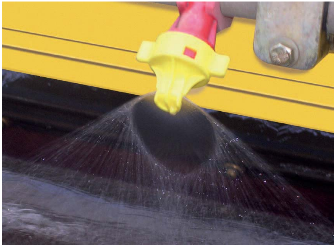
Gli ugelli ad alto rendimento provvedono a distribuire uno strato omogeneo di umidità sulla superficie del tamburo.
