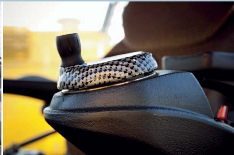
Bastano le dita: la precisa sterzata dei tamburi mediante il volantino.
