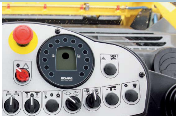
Sicurezza: Gli stop di emergenza e le spie di allarme sono disposti centralmente.
