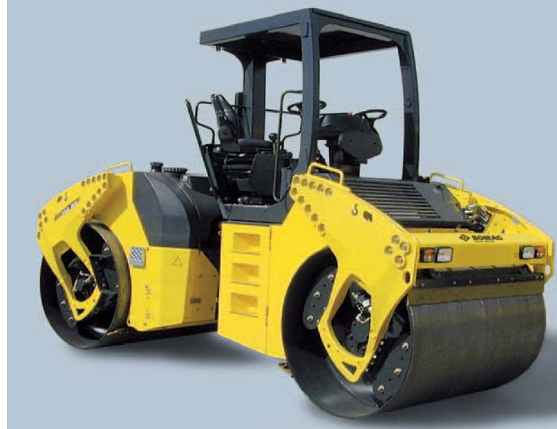
Sicurezza: Posto operatore con ringhiera e ROPS/FOPS.
