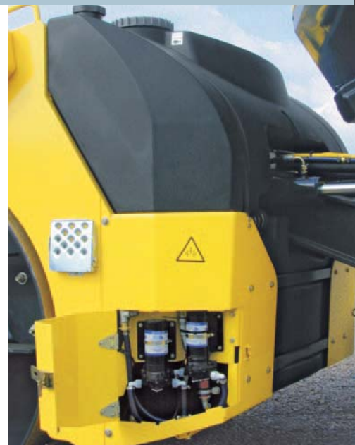
Grandi serbatoi dell'acqua per pochi stop di rifornimento; due pompe dell'acqua.
