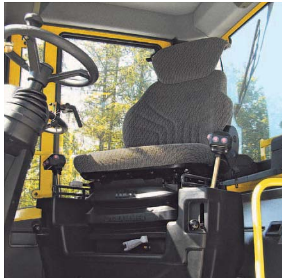
Tutto sotto controllo: Sedile comfort con due leve di marcia.
