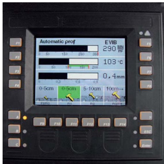
Display centrale per rulli con ASPHALT MANAGER 2.
