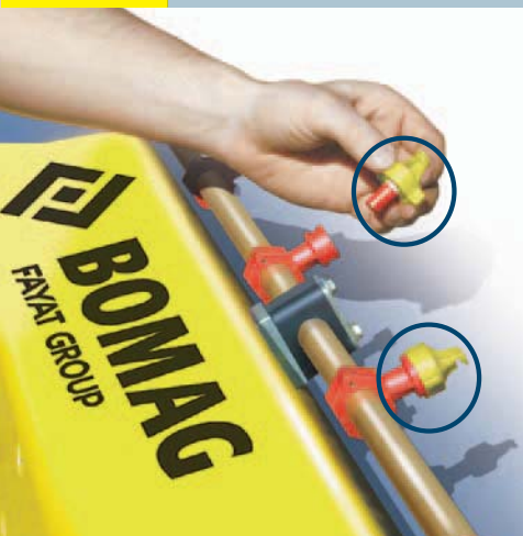
Sei ugelli distribuiscono l'acqua uniformemente; un sistema sicuro con triplice filtraggio.
