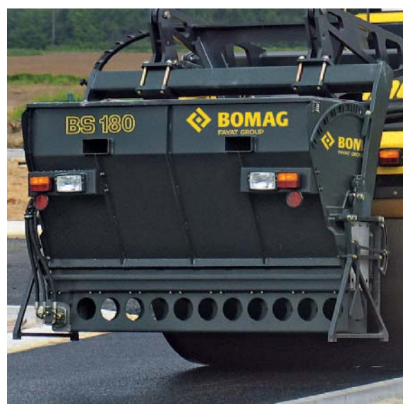
Spandigraniglia di precisione BS 180 per un trattamento preciso e uniforme della superficie.
