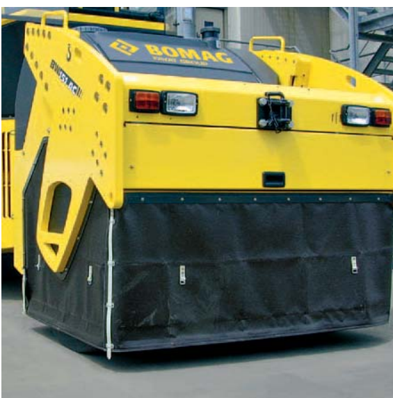
Grembiuli termici: affinché i pneumatici del rullo combinato rimangano caldi più a lungo.
