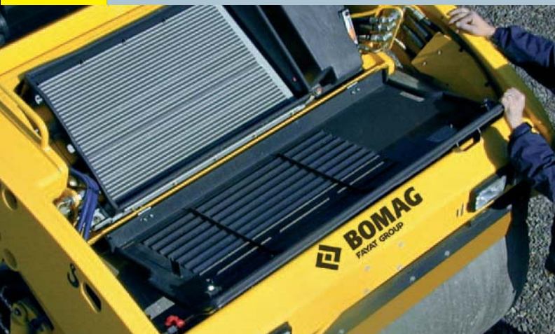
Tutto di facile accesso: Pulizia del radiatore.
