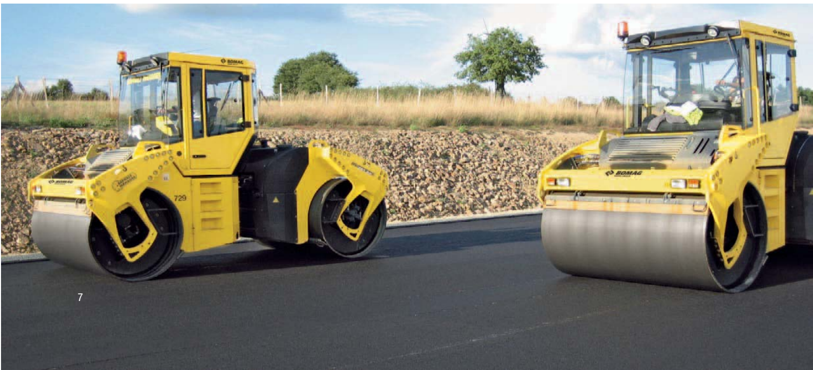
BW 190 AD-AM 2 con regolazione automatica della compattazione.
