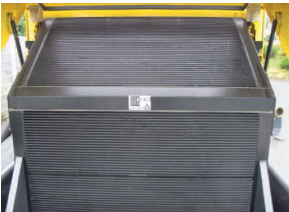
Grandi radiatori con sufficiente riserva di raffreddamento.
