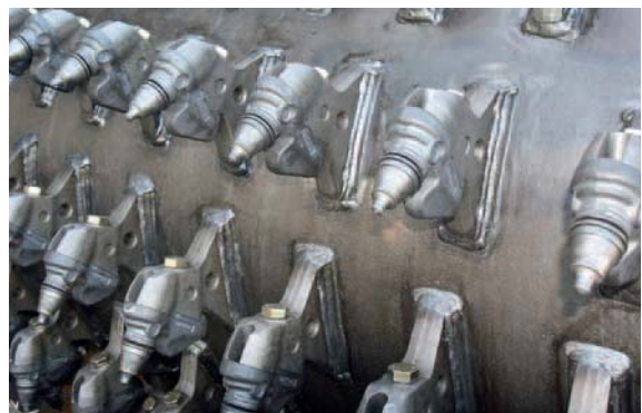
Nuovo sistema BOMAG BRS 05 per il cambio rapido dei portadenti.
