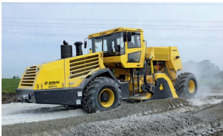
La combinazione di snodo articolato e asse posteriore sterzante mette la MPH 125 a proprio agio sui terreni più difficili.
