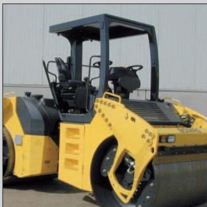
Sicurezza: posto operatore con parapetto e ROPS/FOPS.
