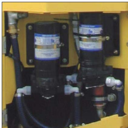
Sistema di spruzzatura dell'acqua con due pompe: comodamente commutabile dal posto operatore.
