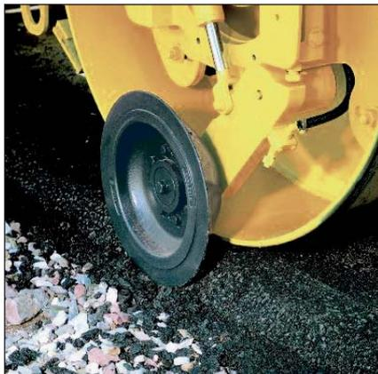
Per un'efficiente lavorazione dei bordi con il disco tagli-asfalto o rulli di pressione.
