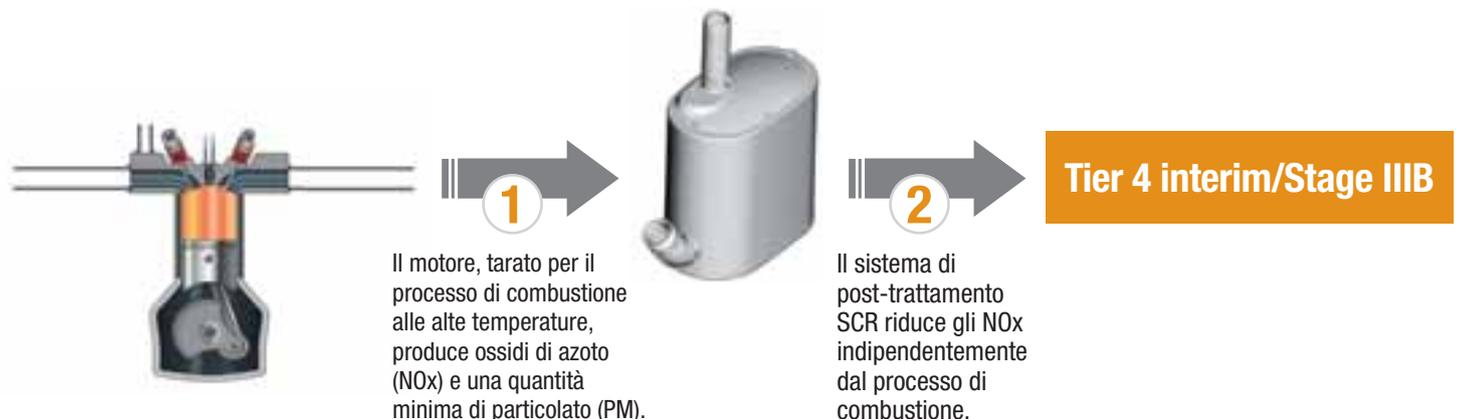
La soluzione "SCR Technology" di Case è costituita da un sistema di post-trattamento che riduce drasticamente le emissioni senza limitare la potenza del motore. La combustione alle alte temperature con aria fresca e pulita (non ricircolata) sviluppa una maggiore potenza con meno carburante, assicurando prestazioni più elevate con consumi ridotti.
