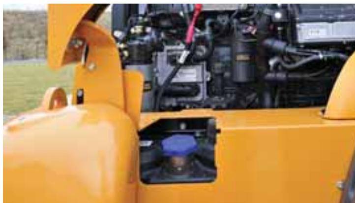
*L'additivo AdBlue® necessita di un solo rifornimento ogni 3 di carburante*
