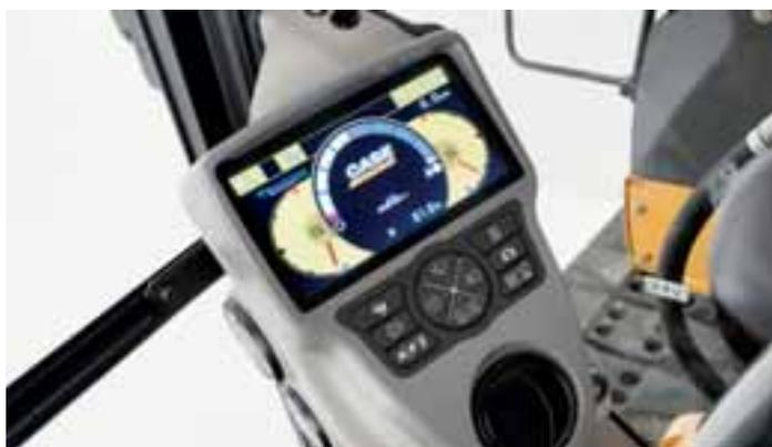
Visualizzatore LCD a colori da 7" della strumentazione: look moderno e completezza di funzioni e informazioni fornite
