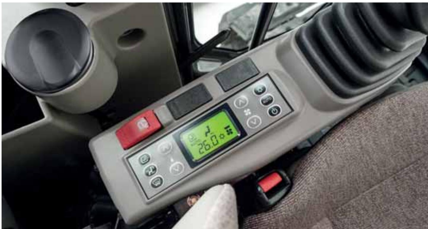
Climatizzatore automatico: eccellente controllo della climatizzazione cabina
