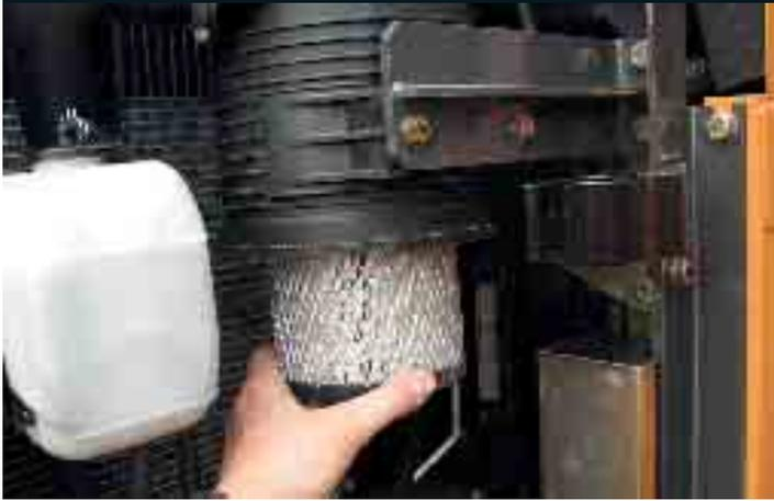
I filtri a distanza nella zona delle pompe idrauliche consentono una semplice manutenzione da terra, con tappi ecologici che evitano che l'olio contaminii il terreno.
