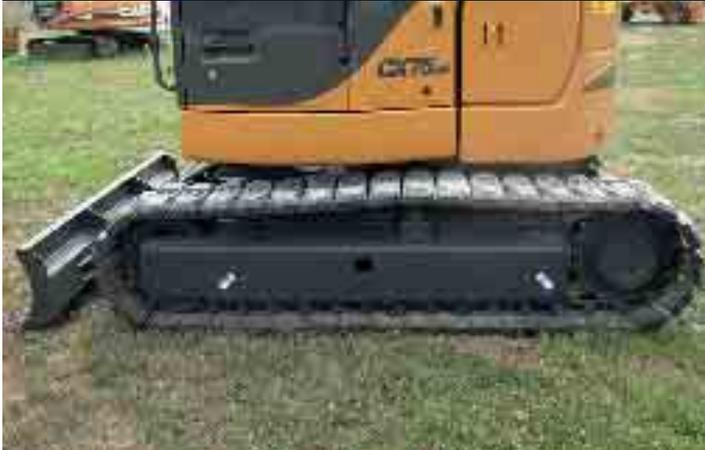
Il design del carro Case garantisce la longevità dei componenti e bassi costi di gestione. Gli escavatori Case hanno ruote motrici termicamente trattate per una maggiore vita utile. Guidacingoli robusti, catenerie migliorate con guarnizioni di tenuta a "M" e perni irrobustiti aumentano la durata e l'affidabilità. Il nuovo profilo dei rulli d'appoggio consente un'usura minore e il disegno dell'O-ring impedisce l'ingresso di materiale abrasivo, a vantaggio della longevità.
