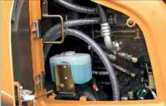
Gli escavatori "Short radius" di Case hanno un efficiente sistema di pompe idrauliche con una cilindrata maggiore per permettere al motore di girare a bassi giri, diminuendo i consumi e le emissioni di scarico. Un filtro idraulico ad alte prestazioni assicura la longevità dei componenti e la loro massima protezione.
