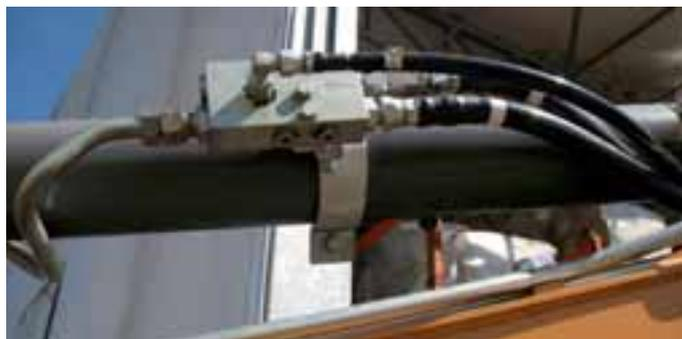
*Valvole di sicurezza incluse nel kit per la movimentazione sicura*
