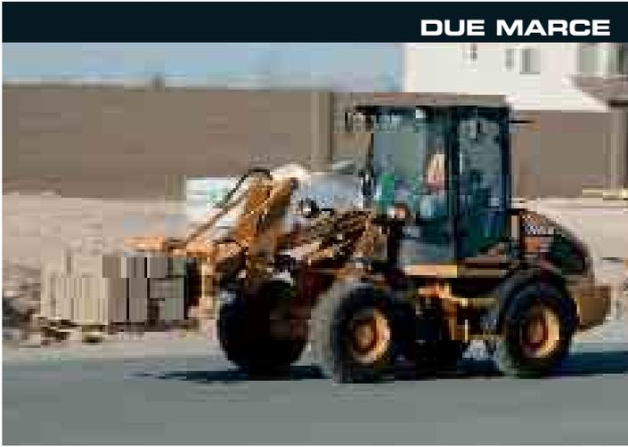
Le pale gommatae compatte Serie E utilizzano un'efficiente trasmissione idrostatica, con due marce fino a 20 km/h per tutti i modelli. La terza marcia opzionale per i modelli 121E, 221E e 321E consente di raggiungere una velocità di 35 km/h. La dotazione di serie include il differenziale a slittamento limitato sull'assale anteriore, opzionale per l'assale posteriore, che assicura la massima trazione quando si opera su terreni difficili.
