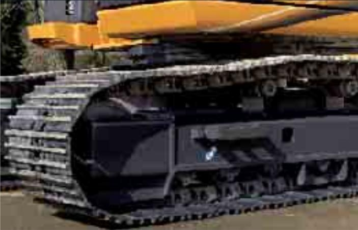
La CX130B è disponibile con un carro di lunghezza standard, con lama opzionale, o con un nuovo carro LC più lungo per la massima stabilità. La lunga durata operativa riduce i costi di gestione; la CX130B è inoltre dotata di ruote motrici termicamente trattate per una maggiore affidabilità. Guidacingoli robusti, su richiesta, catenerie migliorate, con nuove guarnizioni di tenuta a "M" e perni irrobustiti aumentano la longevità, riducendo l'usura dei cingoli.
