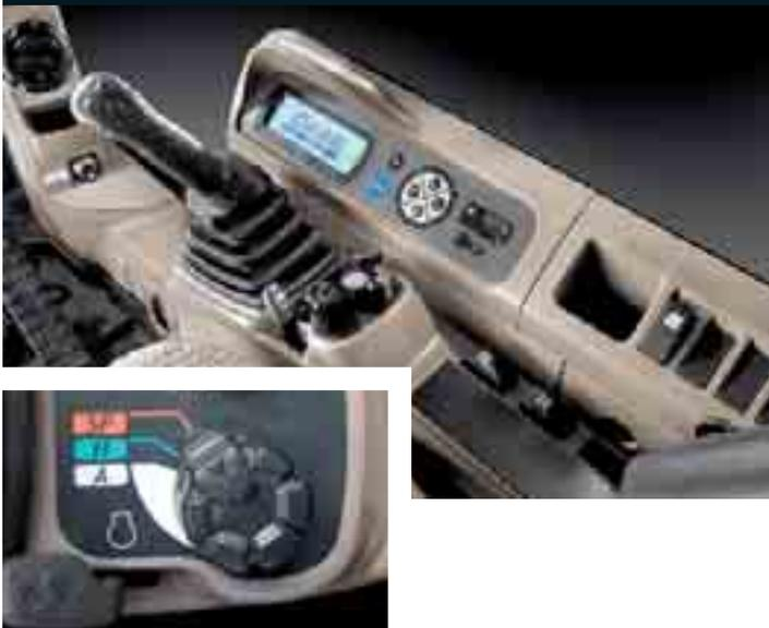
La selezione della modalità dell'impianto idraulico viene operata tramite il comando avanzato dell'acceleratore del motore, posizionato a portata di mano dell'operatore nella console di destra completamente regolabile. Tutti gli interruttori sono raggruppati in posizione centralizzata e i manipolatori corti servoassistiti rendono la CX130B una macchina davvero semplice da operare.
