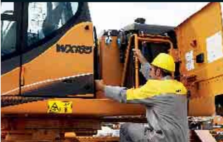
Nonostante il raggio di rotazione posteriore ridotto tipico della Serie Case WX, questo modello prevede la passerella di servizio Case dietro alla cabina, offrendo così un'accessibilità eccellente per tutti gli interventi di manutenzione ordinaria e assistenza, in totale sicurezza. Il cofano motore ribaltabile permette di visualizzare chiaramente la parte superiore del motore, le valvole idrauliche e il modulo di raffreddamento.
