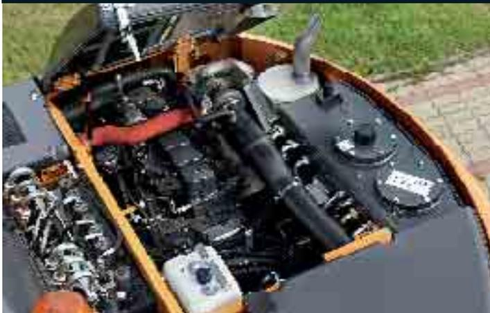
L'escavatore WX185 è azionato da un motore Case a 6 cilindri emisionato Tier III, in grado di sviluppare una potenza fluida e una coppia massima. Questo motore è del tipo turbo con intercooler, per una combustione pulita e una maggior erogazione di potenza. Progettato per la massima affidabilità e longevità, prevede un sistema di pre-riscaldamento automatico che prolunga la durata operativa e riduce i tempi di fermo macchina.
