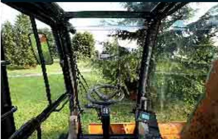
L'ampia superficie vetrata con parabrezza in due pezzi a tutta altezza offre una visibilità panoramica ai vertici della categoria. L'operatore ha una visuale chiara, sia sulla zona di lavoro durante le operazioni di scavo e di caricamento, sia sulla carreggiata stradale durante i trasferimenti da un cantiere all'altro. Il cofano motore ribassato nella parte posteriore della macchina assicura un'ottima visibilità sulla zona di lavoro dietro l'escavatore durante le manovre in spazi ristretti.
