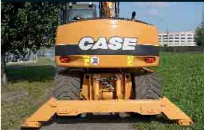
Grazie alla concezione modulare del telaio dei Case WX, è possibile scegliere tra stabilizzatori e lama dozer; oppure utilizzare entrambi. Gli stabilizzatori e la lama dozer sono comandati in modo indipendente, per consentire il livellamento sui terreni accidentati.
