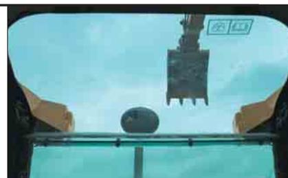
**Tettuccio trasparente.** Il tettuccio trasparente in polycarbonato assicura un'eccellente visibilità verso l'alto.
