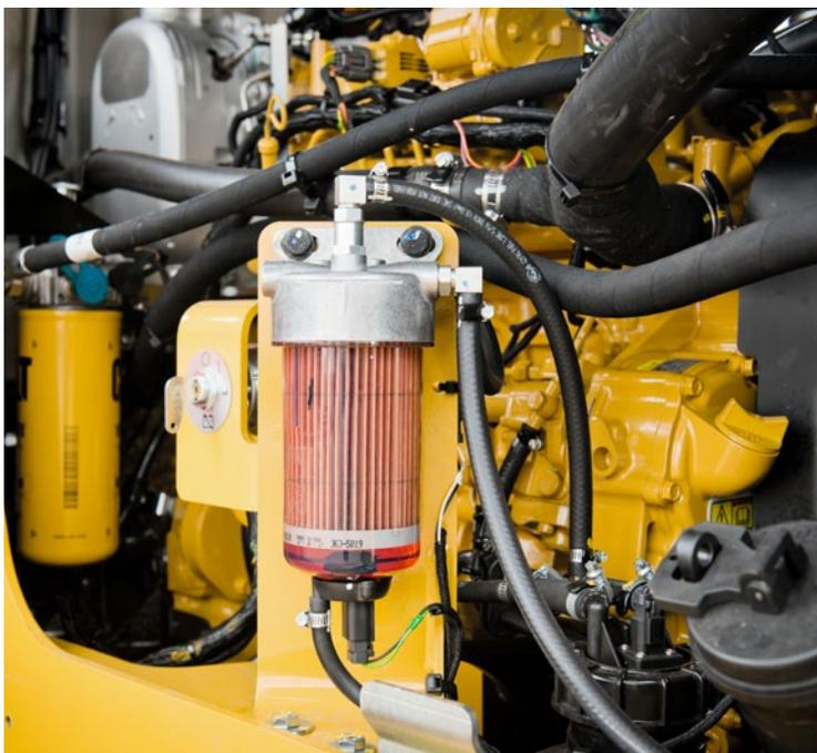
Tutti i punti di manutenzione sono facilmente accessibili. I tre ampi sportelli di manutenzione possono essere aperti e chiusi in qualsiasi ordine per un accesso completo ai filtri e ai punti di manutenzione. Gli intervalli di manutenzione prolungati riducono i tempi di manutenzione e aumentano il tempo di disponibilità della macchina. Le caratteristiche di manutenzione aggiuntive includono:
