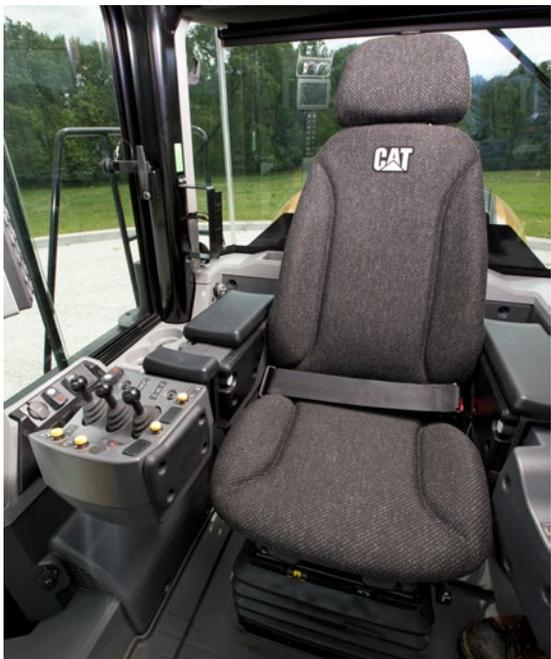
Il miglioramento dell'efficienza dell'operatore resta un obiettivo di progettazione chiave per le pale gommate 966M, 966M XE, 972M e 972M XE. La protezione degli operatori, il senso di sicurezza nel controllo delle macchine, l'ambiente pulito, confortevole e silenzioso con comandi intuitivi azionabili senza sforzo sono tutti fattori che contribuiscono a ridurre l'affaticamento dell'operatore e a migliorare le prestazioni.
