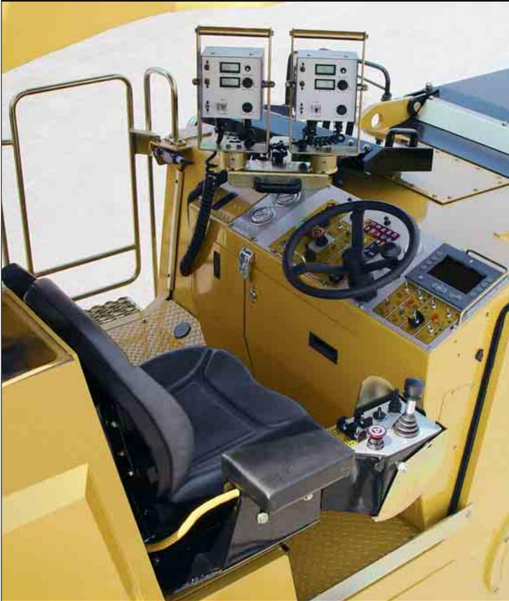
**Posto di guida ergonomico.** La posizione dell'operatore consente una visuale illuminata del nastro di caricamento per un posizionamento rapido e preciso del nastro anteriore.
