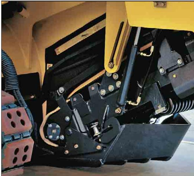
**Dimensioni e gradazione ottimali del materiale.** Il gruppo antiplacca ad azionamento idraulico impedisce il distacco di placche di asfalto, protegge il nastro di raccolta e garantisce una apertura di scarico ottimale nella camera del rotore.
