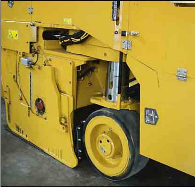
**Trazione integrale.** La trasmissione idrostatica sulle quattro ruote, tramite un divisore di flusso, e l'assale anteriore autolivellante, assicurano un'eccellente trazione ed ottime prestazioni in ogni applicazione.
