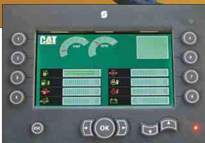
*L'ampio display fornisce i parametri operativi della macchina e del motore, facilitando le diagnosi. (Il display illustrato è a colori)*
