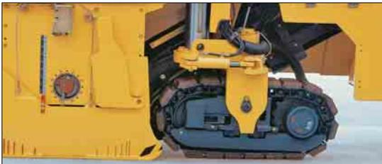
**Taglio a filo muro.** Il cingolo posteriore destro può essere fatto ruotare all'interno della larghezza di taglio della macchina per applicazioni di taglio a filo muro. Con il cingolo posteriore destro ruotato, la macchina può fresare facilmente in prossimità di una parete, una barriera o un altro ostacolo verticale.
