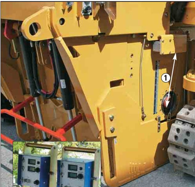
**Sensore longitudinale e a filo (yo-yo).** Il sensore longitudinale misura lo spostamento della paratia laterale; l'intera lunghezza di quest'ultima viene sfruttata per calcolare la media della profondità di taglio longitudinale. Un livellatore trasversale aumenta la versatilità del sistema.
