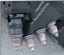
**97 utensili con punte in carburo.** Gli utensili sono montati su portautensili ad innesto rapido in tre sezioni e posizionati con disposizione a tripla spirale, per fornire la massima forza di frantumazione.
