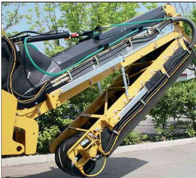
**Nastro pieghevole.** Il trasporto della macchina è facilitato dal nastro anteriore pieghevole che ne riduce le dimensioni.
