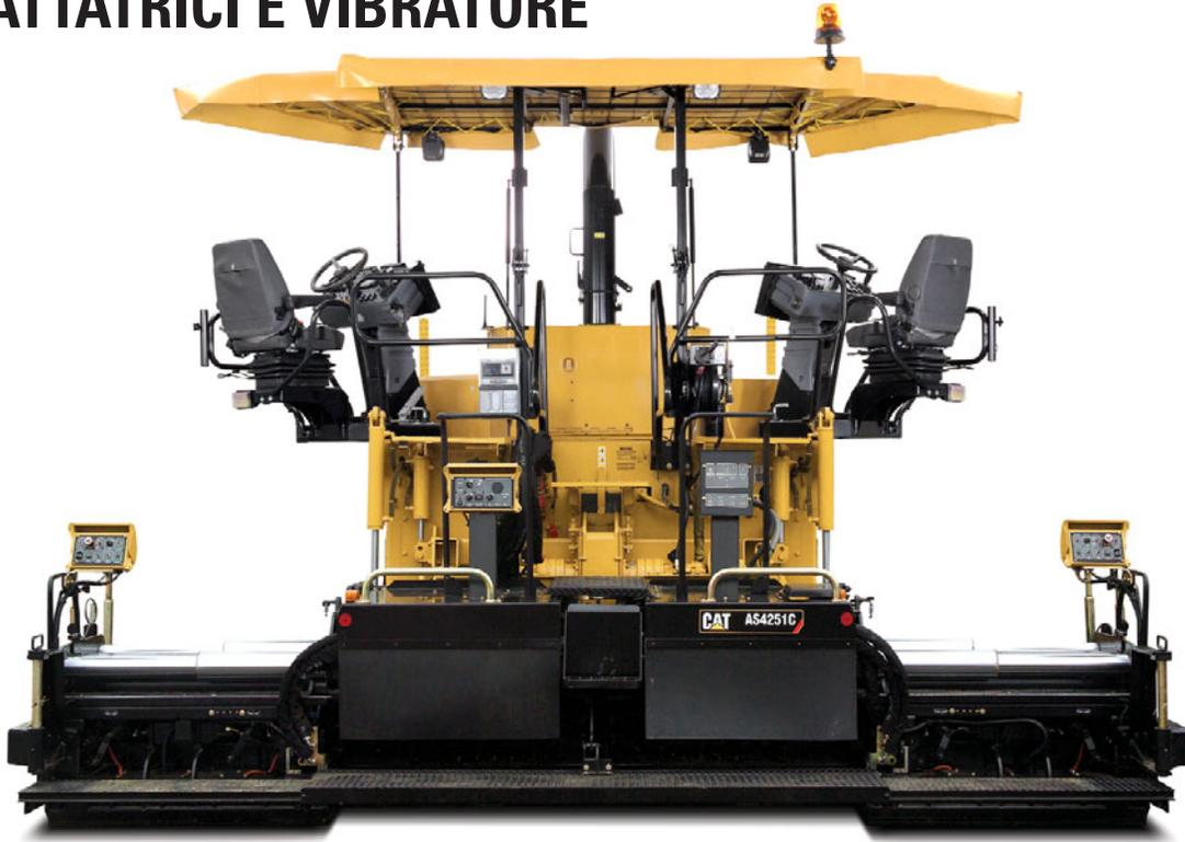
*Le barre compattatrici e le piastre di rasatura vibranti ottimizzano la densità del manto dietro al rasatore.*
