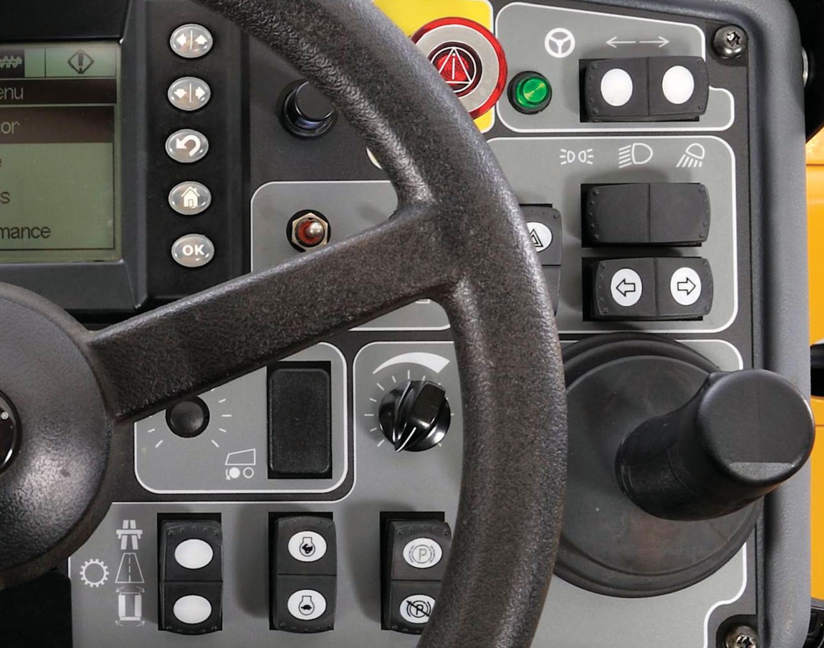
*Le console di comando Cat® utilizzano interruttori di feedback positivo e comandi in punta di dita per favorire la sicurezza dell'operatore.*
