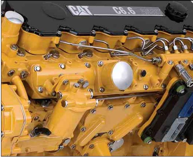
**Motore Cat C6.6 con tecnologia ACERT.** Il motore eroga una potenza lorda (SAE J1995) di 129,5 kW (176 hp) a 2200 giri/min. Il motore è conforme alla normativa europea Stage IIIa in tema di controllo delle emissioni.
