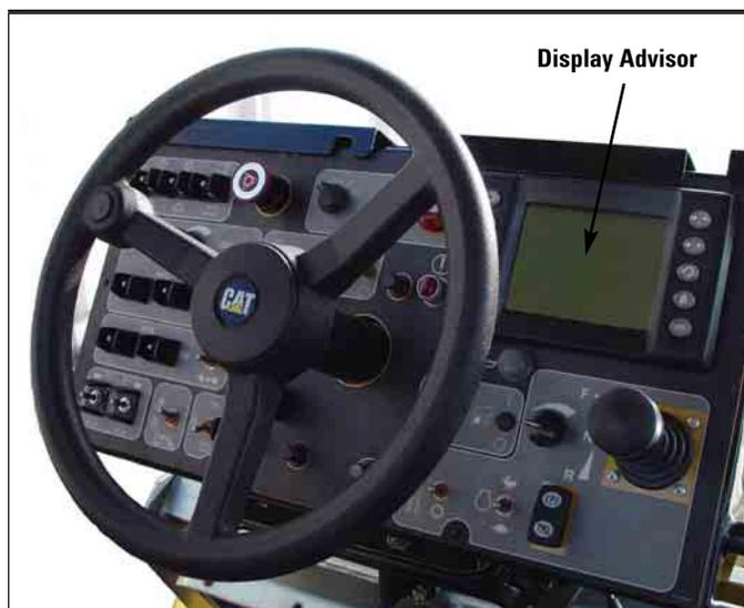
**Sistema di monitoraggio AMS.** Il display LCD Advisory consente l'accesso ad una checklist di avviamento, alle preferenze dell'operatore, ai parametri operativi del motore ed al "Paving Calculator".
