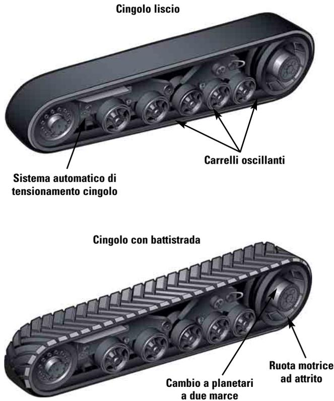
**Carro Mobil-trac.** Il carro Mobil-trac combina i vantaggi del galleggiamento e della trazione di un carro cingolato con la mobilità e comfort di guida di una finitrice gommata. Il sistema Mobil-trac comprende un cingolo in gomma di grande robustezza e durata con uno spesso rivestimento esterno ed una serie di strati interni in cavi d'acciaio flessibili.
