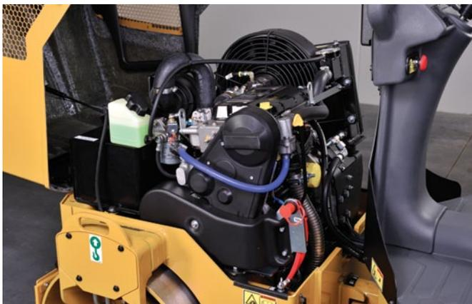
*L'efficienza del motore si traduce in livelli di rumorosità ridotti.*
