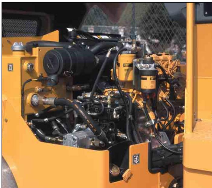
**Cofano motore.** Il cofano motore in vetroresina si apre verso l'alto e si blocca in posizione aperta tramite un'asta dedicata.
