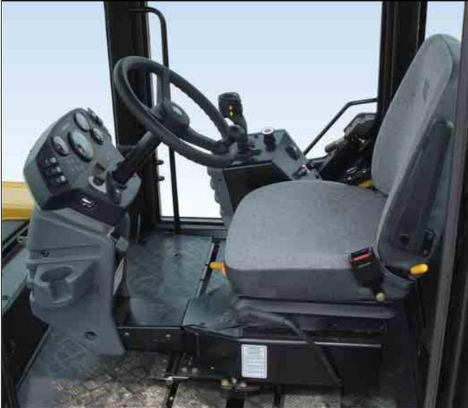
**Sedile.** Il sedile a sospensione, robusto e confortevole, è totalmente regolabile e fornito di braccioli ribaltabili e cintura di sicurezza da 76 mm auto avvolgente.
