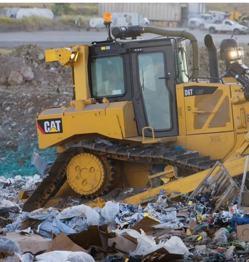
Il movimentatore di rifiuti D6T dispone di una ruota motrice rialzata Cat che isola i riduttori finali, gli assali e i componenti dello sterzo da impatti violenti. Il carro è progettato per garantire una facile pulizia ed è dotato di una struttura modulare che semplifica la manutenzione e contribuisce a ridurre i costi di manutenzione.
