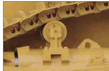
**Supporto rullo integrato.** Un supporto per un rullo superiore è integrato all'interno del telaio, rendendo così più agevole il montaggio sul campo nel caso l'applicazione lo richieda.
