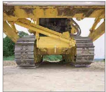
**Barra di collegamento.** Il disegno della barra di collegamento permette di mantenere la lama molto vicino al trattore, garantendo così un controllo più preciso della lama e del carico.
