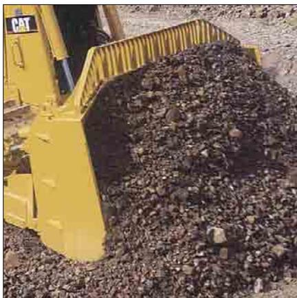
**Lame.** Tutte le lame sono caratterizzate da una robusta costruzione scatolare resistente alle gravose sollecitazioni flessionali e torsionali. Le lame sono realizzate in acciaio Cat DH-2™, ad elevata resistenza. La costruzione robusta della lama e l'utilizzo di salvataglianti imbullonati e terminali induriti assicura la massima affidabilità e durata.
