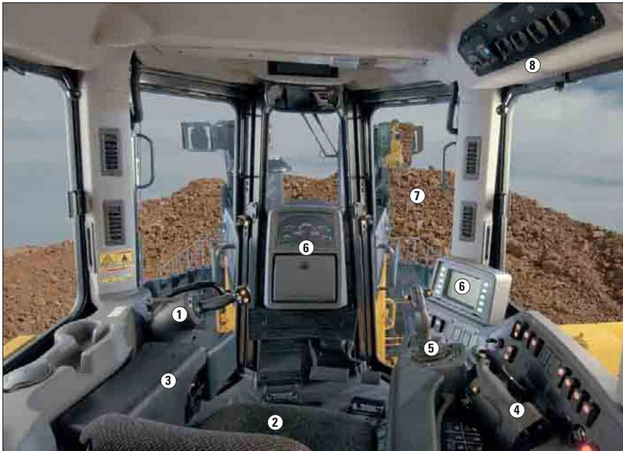
**1) Comando dello sterzo.** Con il differenziale di sterzo i comandi di sterzo, di marcia e di direzione sono integrati in una leva singola di facile azionamento.
