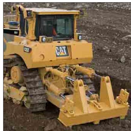
**Ripper.** I ripper monodente e multidente sono di estrema robustezza e realizzati per lavorare con efficienza in una vasta gamma di materiali.
