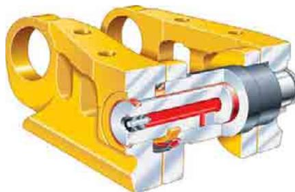
**Sistema di fissaggio perni (PPR).**
