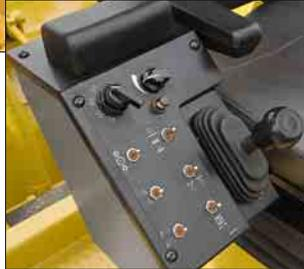
*La console di comando laterale è provvista di bracciolo imbottito, selettore per le quattro modalità di sterzata, indicatore di controllo della velocità, leva di comando, selettori di sollevamento del rotore, selettore del portello della cassa anteriore e posteriore del rotore, selettore di sterzata posteriore e selettore per la traslazione del posto di guida.*
