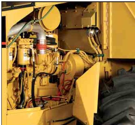
*I punti di manutenzione sono accessibili da terra e raggruppati su un lato del motore. Pannelli laterali incernierati, accessibili da terra, consentono un ampio accesso ai componenti del motore; i pannelli inferiori possono essere anche rimossi, per migliorare ulteriormente l'accesso.*
