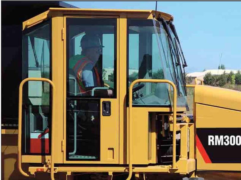
**Cabina pressurizzata.** La cabina è pressurizzata per garantire l'esclusione di rumore, polvere e materiale ed esaltare il comfort interno.
