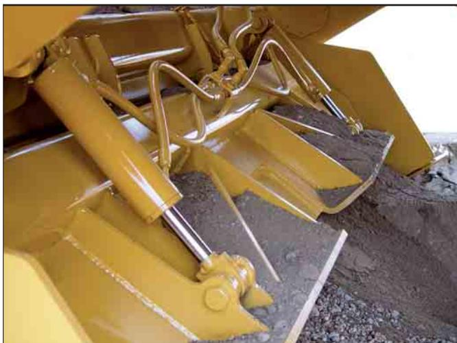
**Portello anteriore ad azionamento idraulico.** Consente all'operatore di controllare l'apertura dal posto di guida.
