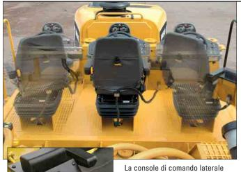
La console di comando laterale è provvista di bracciolo imbottito, selettore per le quattro modalità di sterzata, indicatore di controllo della velocità, leva di comando, selettori di sollevamento del rotore, selettore del portellodella cassa anteriore e posteriore del rotore, selettore di sterzata posteriore e selettore per la traslazione del posto di quida.
