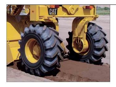
**Impianto a doppia pompa di traslazione.** Una pompa è dedicata alla trazione delle ruote anteriori mentre l'altra è dedicata alla trazione delle ruote posteriori.
