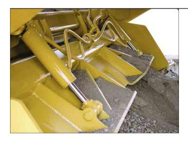
**Portello anteriore ad azionamento idraulico.** Consente all'operatore di controllarne l'apertura dal posto di guida.
