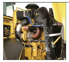
Grande cofano motore in vetroresina in un unico corpo ribaltabile per consentire un facile accesso al motore ed al sistema di raffreddamento. I punti di manutenzione sono accessibili da terra e raggruppati su un lato del motore. I pannelli inferiori apribili offrono un agevole accesso.
